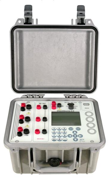
Die CheckSource 2.3 ist eine dreiphasige Stromquelle für Ströme bis 6 A. Die Ströme in den einzelnen Phasen werden mit derselben Frequenz und benutzerdefinierten Phasenverschiebung zu den Spannungen generiert, welche an den Spannungseingängen angelegt werden. Wahlweise können die Messströme auch mit einer benutzerdefinierten Frequenz generiert werden.
